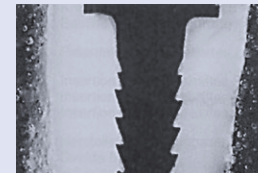
Exatec-S Wurzelstift exakt passgenauer Sitz mit Glasionemerkement Ketac Cem Radiopaque, auf Grund der kleinen Korngröße von 0,1 bis 1,2 µm (Vergrößerung 10x)
